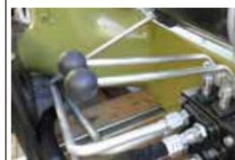
アウトリガーレグの上下動作はベース部に装備された操作バルブにより地上位置で行います。ブームの左右張り出しは手動で行います。
