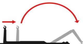
スライド式のフックアームにより、作業に応じてコンテナの前進/後退を行ないます。スライド式は、諸元の範囲内でコンテナ長を設計する事が可能です。
