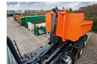
スライド動作時に自動でコンテナを少し浮かせる事により、コンテナとフレームの摩擦を最小限に抑え装置への負荷も減らします。コンテナと装置の耐久性が向上します。
