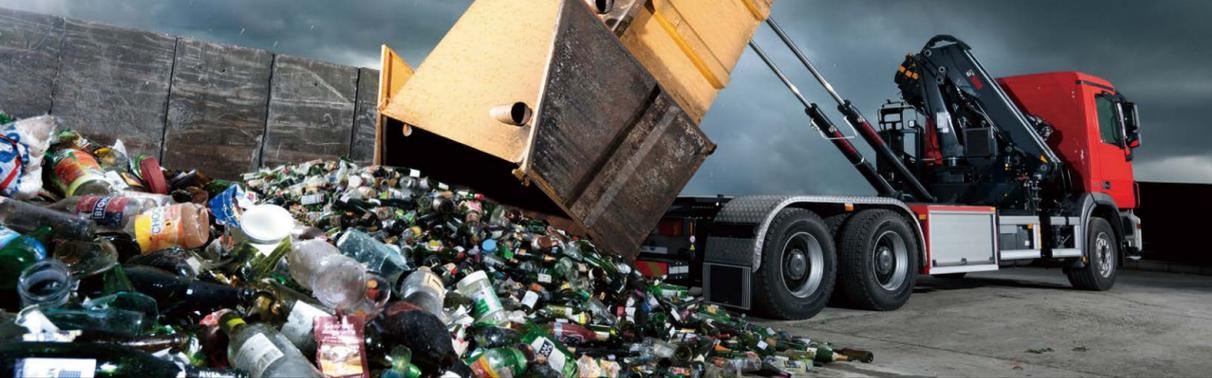
ULTIMAシリーズはGVW20ton以上の車両向けに、能力と重量の最適なバランスをテーマに設計されました。余裕のパワーを与えられながら、無負荷時の動作スピードを上げるなど独自の機能を搭載し、生産性アップに貢献します。
