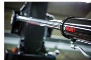
シリンダーのストロークエンドで自動的にスピードを緩めて衝撃を和らげます。シリンダーを保護すると共に、装置とコンテナへの衝撃を抑えます。
