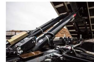
コンテナの積込時、最後にフレーム着床する手前で、自動的にスピードを緩めてスムーズな格納をサポートします。トラックへの衝撃と騒音を軽減する、作業環境に配慮した機能です。
