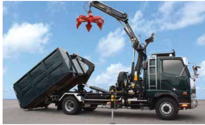
ヒアブ XS088BS-2SC + XR10JS マルチリフトとヒアブクレーンによる産業廃棄物運搬システム車
