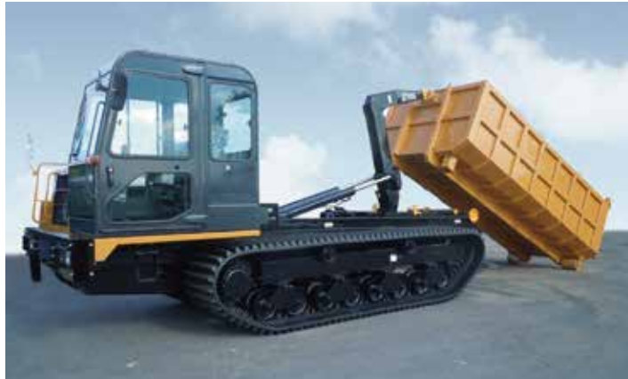
林内作業車 + XR10JS 不整地走行に適した林内作業車との組合せ
