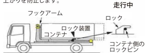
丸棒ロックにより、コンテナのロックピン(丸棒)をしっかりつかみます。
