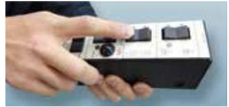
運転席にセットされたコントロールボックスにより、キャブ内からマルチリフトを操作します。コントロールボックスはケーブルで接続されており、取り外してキャブ外からの操作も可能です。
