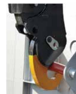
コンテナ掛け外し動作時
