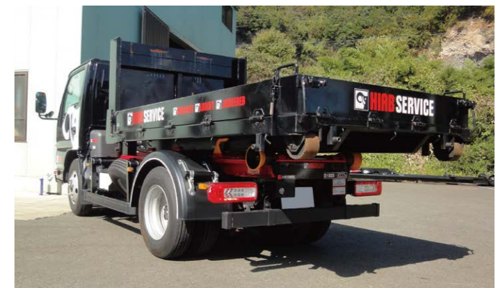
※写真の車両はHIABのサービスカー。コンテナを後方にスライドした状態です。
