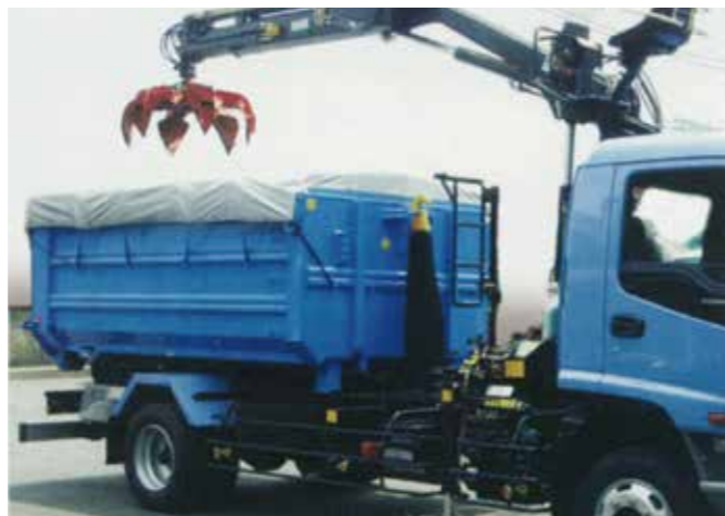
ヒアブ XS088BS-2SC + XR7J マルチリフトとヒアブクレーンによる産業廃棄物運搬システム車
