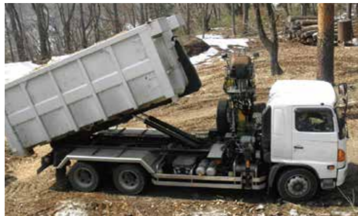
ログリフト61Z + XR10J マルチリフトとログリフトクレーンによるチップ材運搬システム車
