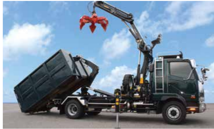
Hiab XS088BS-2SC + XR10JS マルチリフトとHiabクレーンによる産業廃棄物運搬システム車
