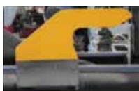
丸棒ロックによりコンテナのロックピン(丸棒)をしっかりとつかみます。
