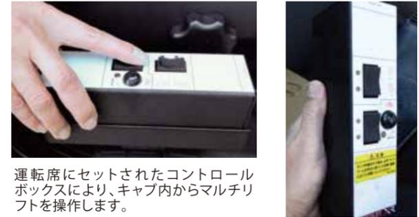
運転席にセットされたコントロールボックスにより、キャブ内からマルチリフトを操作します。
