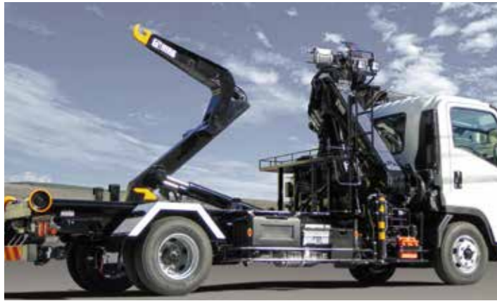
Hiab XS077BS-2SC + XR7T マルチリフトとHiabクレーンで構成されたシステム車は様々な作業に対応
